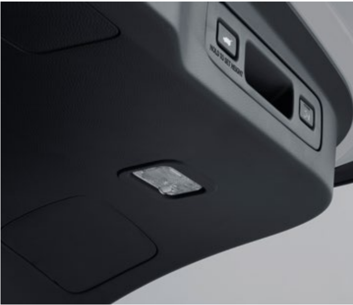
Oryginalne, dodatkowe oświetlenie przestrzeni ładunkowej zostało opracowane, aby zwiększyć komfort i bezpieczeństwo poprzez oświetlenie nie tylko samego bagażnika, ale również przestrzeni za samochodem. Dwie diody LED zainstalowane w tylnej klapie zapewniają bardzo mocne światło, nawet w sytuacji gdy auto jest w pełni załadowane. Oświetlenie włącza się natychmiast po otwarciu pokryw bagażnika.
