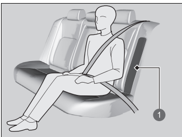
1 Położenie bocznej poduszki powietrznej
